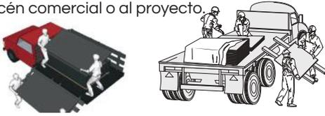
Manipular las láminas siempre de canto, evitando deflexiones en posición horizontal
