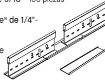
**AXSJ-Axiom® Junta Deslizante** - Se utiliza para unir dos sistemas de plafones acústicos en instalaciones sísmicas D, E, F. También puede utilizarse para unir dos sistemas de plafón diferentes. Agujeros de alambre de colgante cada 6", comenzando a 3" de cada extremo.
