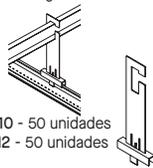
**SH12** - Soporte colgante PeakForm® - Para sistemas de suspensión con orificio ciego de 12" a 12" a eje.
