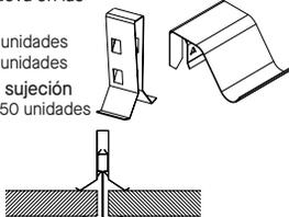
**BHDC** - Clip de sujeción de bordes - Se fija a la moldura angular para sujetar los plafones perimetrales. Fabricado en acero inoxidable.
