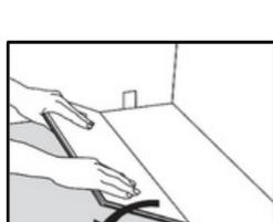
5. La segunda fila del piso SPC y el suelo mantienen un bisel de **30°** y se insertan en la fila anterior. Dóblela hacia abajo y empújela hacia delante para que quede bien ajustada.
