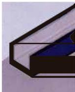
Retirar el papel siliconado de la Akustik Banda, aplicar sobre el alma y alas de la solera inferior y fijar el perfil a la losa.
