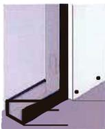
Fijar mecánicamente la placa, según las recomendaciones del fabricante.
